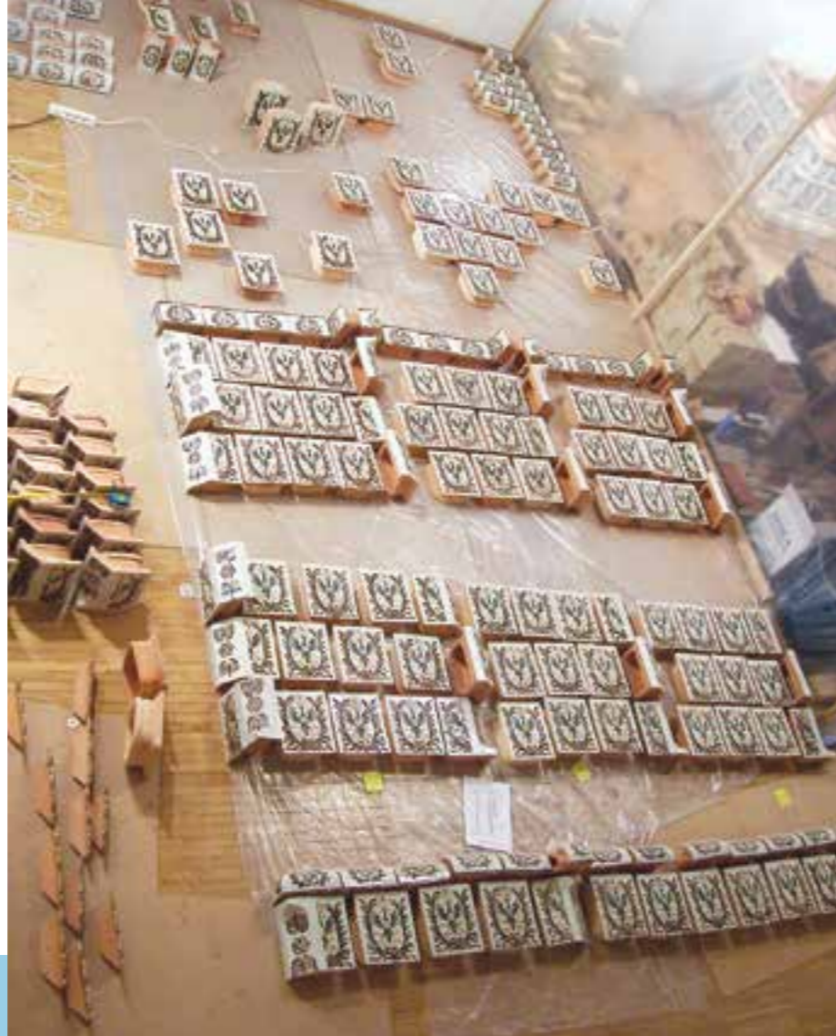
Biržų pilies XVII a. krosnies rekonstrukcija, naudojant vietinę archeologinę medžiagą (šiuo metu krašto muziejus „Sėla“). Projekto aut. D. Strazdas, koklius pagamino krosnį pastatė VšĮ „Vilniaus puodžių cechas“, vad. D. Strazdas, 2006 m. Foto A. Stellaccio.
